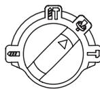
Tilstand til justering af vinklen på mejslens chuck
